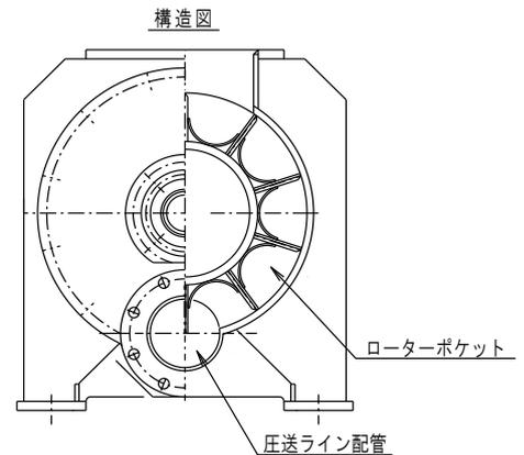
ブローアと組み合わせることにより簡単に圧送装置となるロータリーバルブです。
